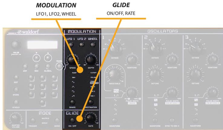
**Shape:** l'utente può selezionare la forma d'onda modulante, dal dente di sega (sawtooth) al generatore casuale (random). Un'onda sinusoidale o un triangolo sono generalmente utilizzati per ottenere effetti simmetrici (come Vibrato o Tremolo) mentre le altre forme sono selezionati dal gusto dell'utente o particolari obiettivi di ricerca del suono. I controlli di velocità e profondità agiscono rispettivamente sui relativi parametri.
